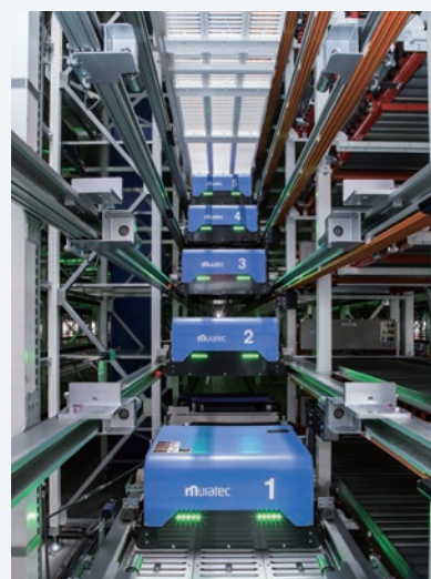
ユニシャトル(高速自動入出庫装置)
